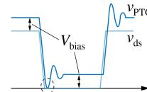
**Fig. 14:** Simplified  $v_{\text{ds}}$  and  $v_{\text{PTO}}$  waveforms highlighting the effect of  $V_{\text{bias}}$  in (d).
